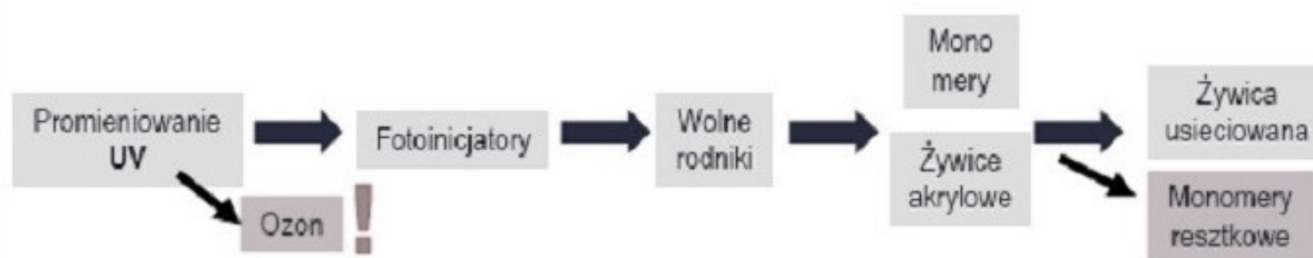
Rys.2.7. Schemat przebiegu reakcji fotopolimeryzacji rodnikowej. Źródło [17]
